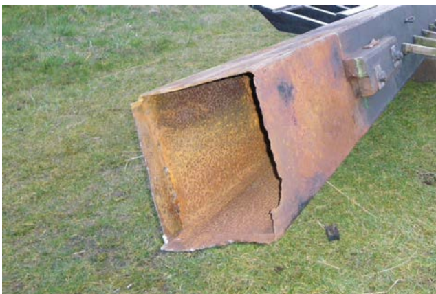
Breuk veroorzaakt door zware corrosie
