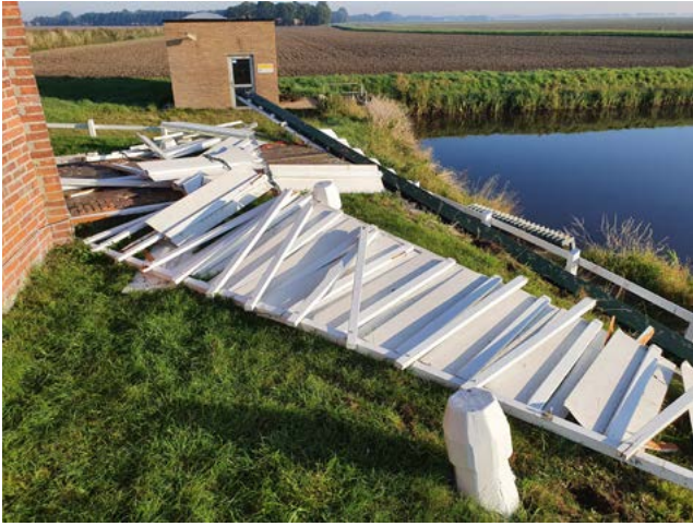
Zelfzwichting na roedebreuk bij molen De Dellen: een zwaarder wiekstelsysteem
