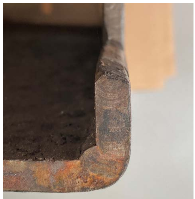
Breukvlak van een roedebreuk veroorzaakt door spanningsconcentraties
