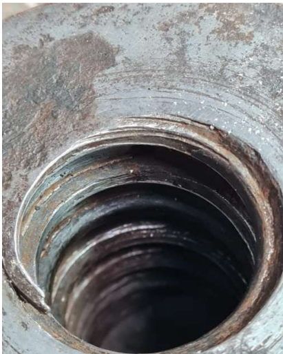
Linksonder zit een stukje schroefdraad los
