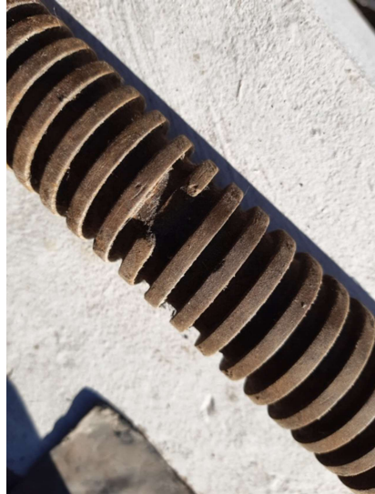
Beschadiging schroefdraad spindel
