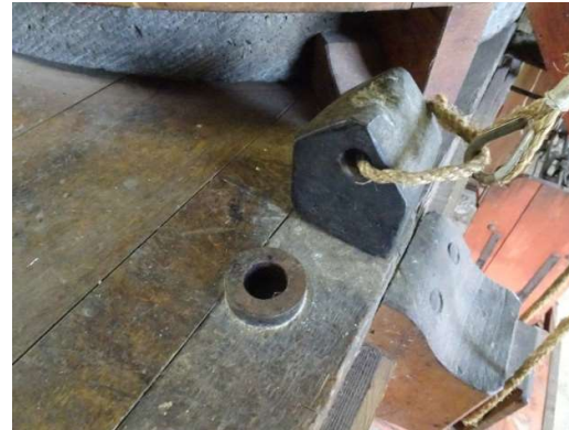
Taatspot schoon, staat vast en balken eronder stevig
