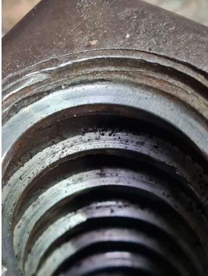
Slijtage bovenzijde schroefdraad moer
