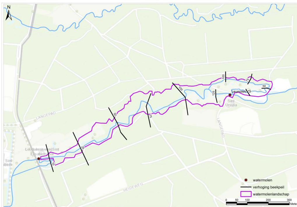
Figuur 3.2 Stuwschaduw: hydrologische invloedssfeer (drooglegging <150 cm-mv) en opstuwing op de beek bij gemiddelde afvoer (1 m 3 /s)
